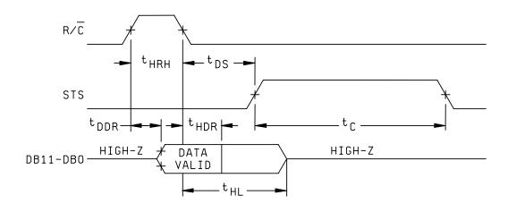
HIGH PULSE FOR R /  $\overline{C}$  - OUTPUTS ENABLED WHILE R /  $\overline{C}$  HIGH, OTHERWISE HIGH - Z
